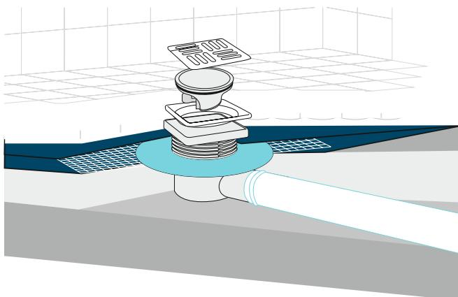
Kendinden yalıtım fileli veya elastomer etekli alt gövdeler sürme su yalıtımı uygulamaları için tasarlanmış ürünlerdir. Sürme su yalıtım malzemelerine tam tutunma sağlayan yalıtım filesinin yanısıra aderansı artırmak için alt gövdeye bütünlük, zamanla açılma riski olmayan yalıtım tekstili özel yöntemler ile eklenmiştir.
