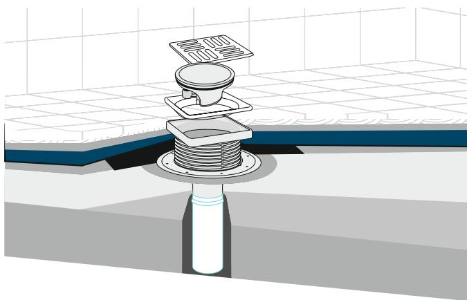
Sukar'ın Flanş sistemli alt gövde tasarımlı ürünün her tür su yalıtım malzemesiyle uyumlu olmasını sağlamaktadır. Sisteme sürme su yalıtımı malzemelerine uyum sağlayabilmesi için yalıtım filesi veya yalıtım tekstili eklenebildiği gibi serme
