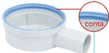
Sukar ürünlerinde bulunan lamine sızdırmazlık contası alt gövde ile üst gövde arasında mükemmel bir su yalımı sağlar. Lamine sızdırmazlık contasının uygulanamadığı alt gövde tiplerinde ise bu işlevi üstlenecek bir conta mutlaka düşünülmüştür. Bu alternatiflerde conta kullanmayarak ikiz gider oluşturma işlevi sağlanabilmektedir.
